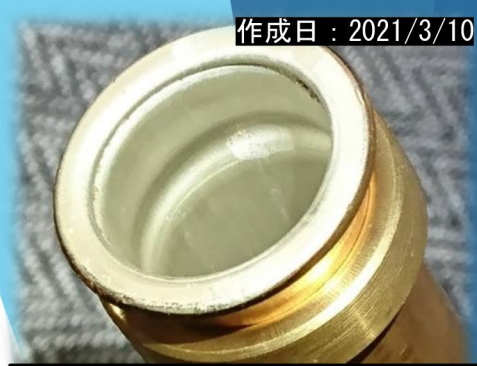
試作事例) Cu管内に錫 (Sn) めっき
